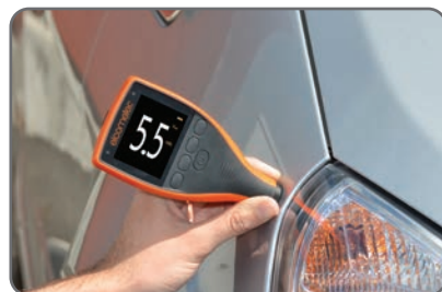
Pantalla con giro automático de 360° para obtener mediciones con cualquier ángulo
