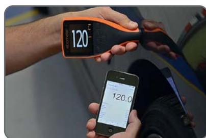
Sortie de données via USB et Bluetooth® 5 vers appareils iPhone ou Android™
