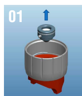
1.- Retirar el TIP de la boquilla
