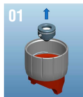
1.- Rimuovere il TIP dall'ugello ad aria
